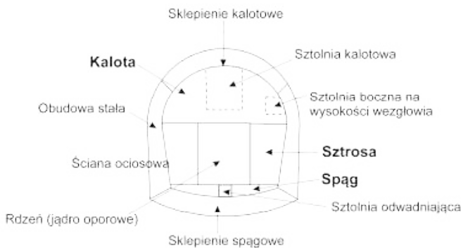
3. Przekrój poprzeczny tunelu z podstawowym nazewnictwem stref wyrobiska i elementów obudowy stałej
